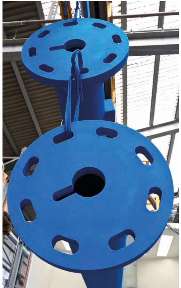
*Glatter Verlauf und gleichmässige Schichtdicken zeichnen den Niedertemperatur-Pulverlack aus.*
