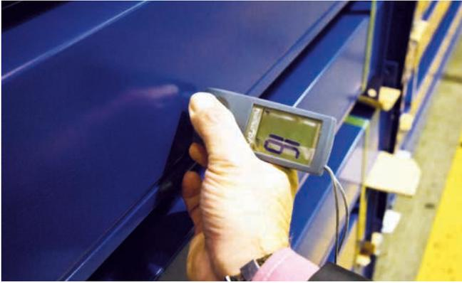
*Mit dem Ultradünnschicht-NT-Pulverlack werden mit 16 µm Schichtdicke eine hohe Deckkraft und glatte Oberflächen erzielt.*
