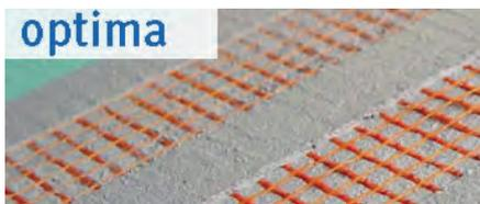
Putzstrukturen mit feinem Korn (0.8 bis 1.6 mm) sind als Systemkomponente optima (= 2-lagige Gewebeeinbettung, Stumpf gestossen, nicht überlappt, Stösse 50 cm versetzt) auszuführen. Die doppelte, nicht überlappte Gewebeeinbettung verringert Unebenheiten, welche im Streiflicht sichtbar werden können.
